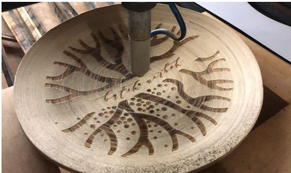
Gambar 10: Proses ukiran menggunakan laser di atas permukaan pinggan buluh
